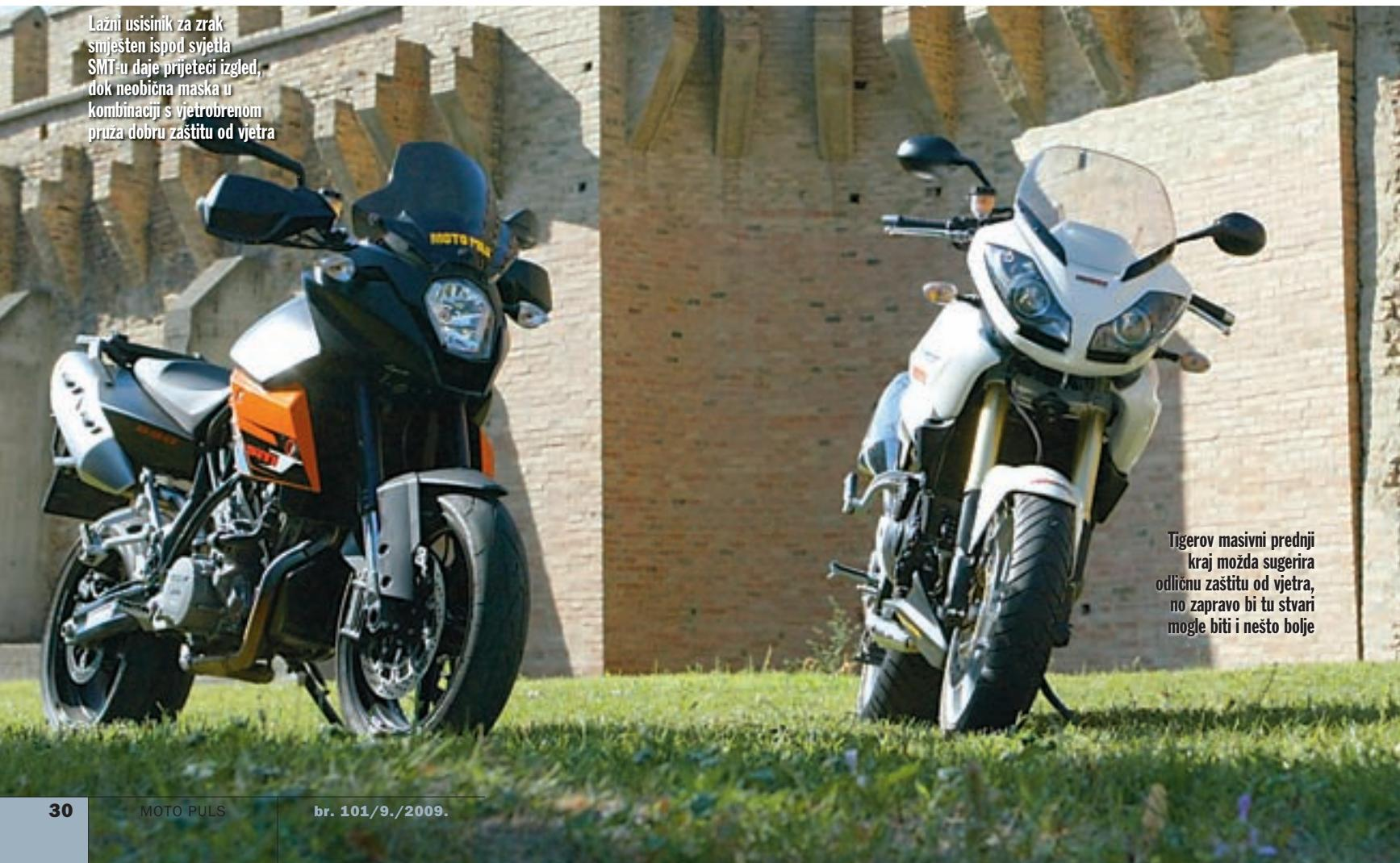
Lažni usisnik za zrak smješten ispod svjetla SMT-u daje prijetiće izgled, dok neobična maska u kombinaciji s vjetrobrenom pruža dobru zaštitu od vjetra
