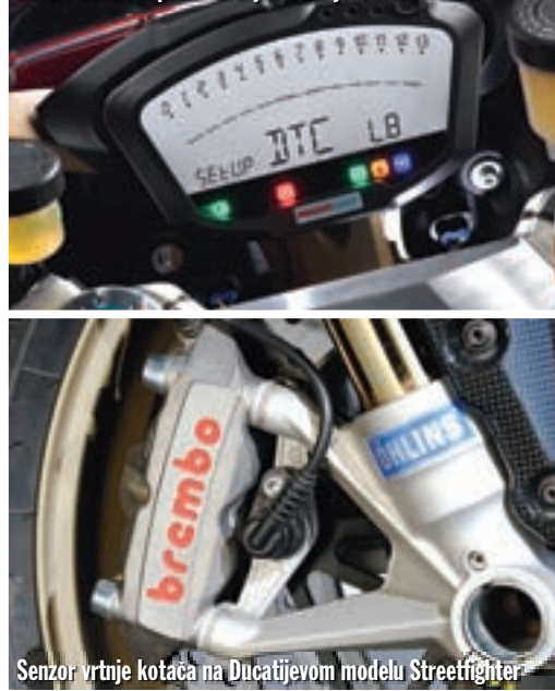
DTC ili Ducati Traction Control, trenutačno najsofisticiraniji sustav kontrole proklizavanja na serijskom motociklu
