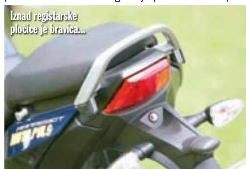
...pomoću koje se otvara stražnje sjedalo i pristupa spremniku goriva
