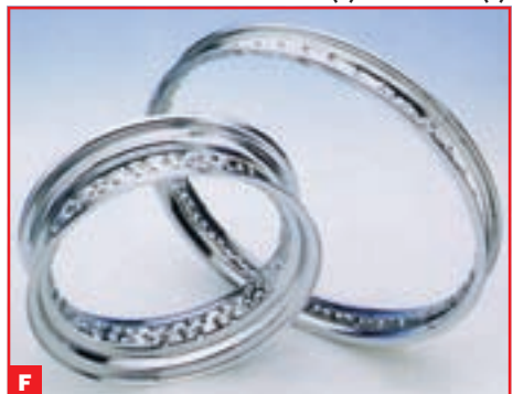
Stari tip željeznog obruča (A) i aluminijskog (B), s vanjskim bočnim rebrom, ojačanjem u zoni najvećeg vlačnog napreznja. Moderni čelični obruč (C) i onaj od aluminijske legure (D), bez perforacija za 'niple'. Lijevo vidimo specijalne obruče sa lateralno postavljenim žbicama (E) i sa 80 žbica (F)
