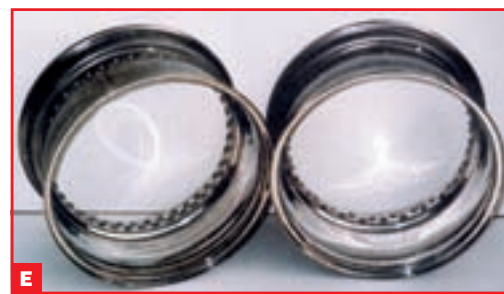
Stari tip željeznog obruča (A) i aluminijskog (B), s vanjskim bočnim rebrom, ojačanjem u zoni najvećeg vlačnog napreznja. Moderni čelični obruč (C) i onaj od aluminijske legure (D), bez perforacija za 'niple'. Lijevo vidimo specijalne obruče sa lateralno postavljenim žbicama (E) i sa 80 žbica (F)
