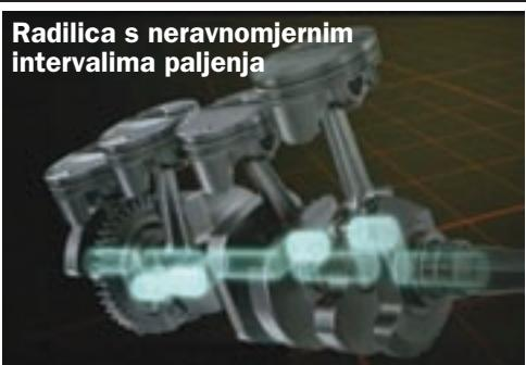
Radilica s neravnomjernim intervalima paljenja
