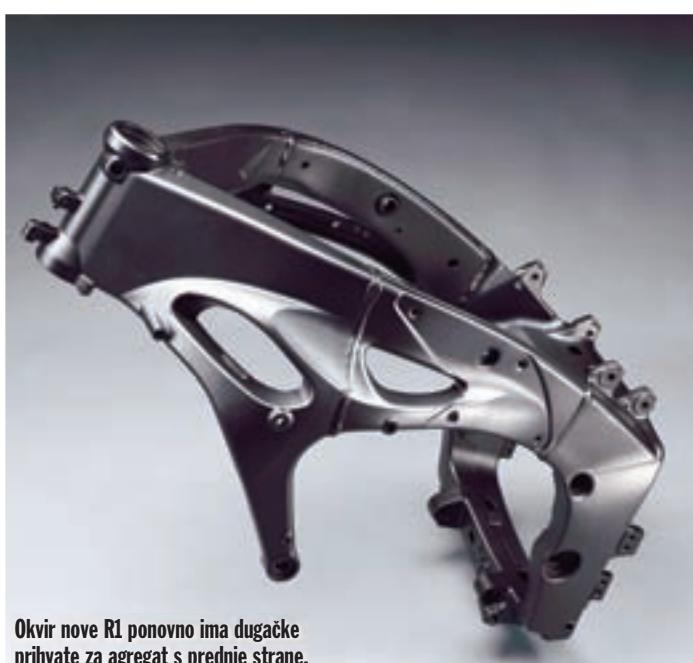
Okvir nove R1 ponovo ima dugačke prihvate za agregat s prednje strane. Napravljeni su i posebni elementi koji dopuštaju kontrolirana uvijanja
