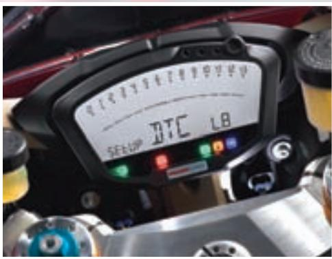
► Nova 'stara' instrument ploča sada obavještava vozača i o stupnju uključenosti sustava kontrole proklizavanja
