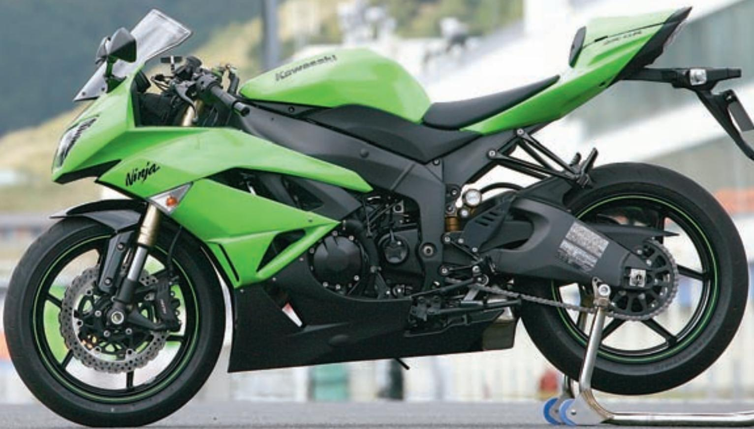
trag je sa 110 mm smanjen na 103 mm. Dodajmo tome i međuosovinski razmak, koji je također smanjen za pet milimetara i sada iznosi 1400 mm. Već iz tih nekih osnovnih parametara možemo naslutiti kako je nova 'šestica' po agilnosti mali vrag u odnosu na dosadašnji model. No,
