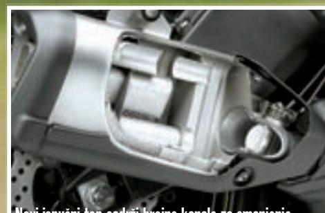
Novi ispušni top sadrži brojne kanale za smanjenje buke, te ispušni ventil pogonjen elektronikom
