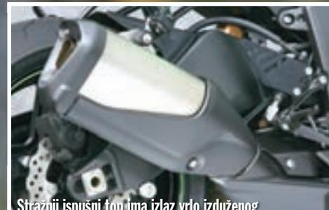
Stržnji ispušni top ima izlaz vrlo izduženog i nepravilnog oblika, a ispred njega se nalazi katalizator u loncu pokrivenom crnim limom
