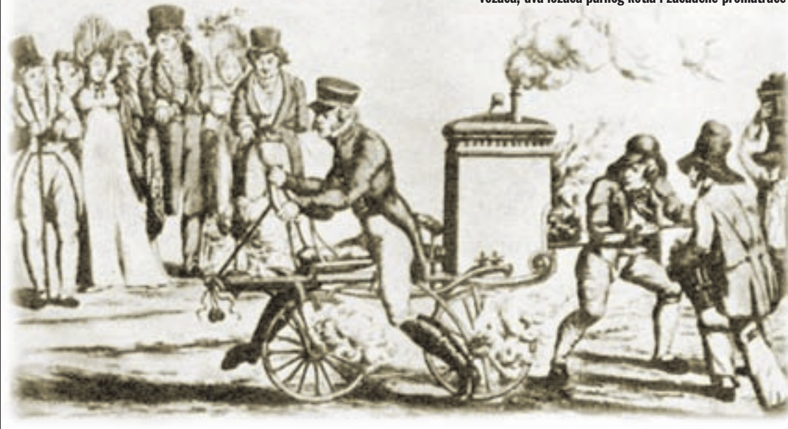
Britanski tisak zabilježio je do tada neviđeni prizor u Parizu: vozilo na dva kotača pogonjeno parnim strojem. Na slici vidimo vozača, dva ložača parnog kotla i začuđene promatrače
