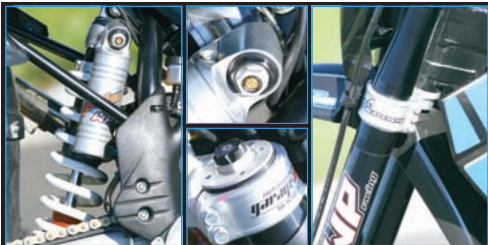
Profesionalne komponente WP ovjesa već su serijski podešene po supermoto parametrima. S gornje strane prednje upside-down vilice nalazi se kotačić za regulaciju predopterećenja opruge
