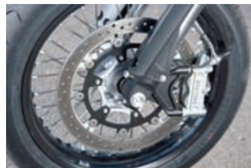
Agresivna prednja kočnica s Brembovim radijalnim klijestima i velikim diskom trenutno zaustavlja motocikl, ali i uzrokuje putovanje vozača po klizavom sjedalu
