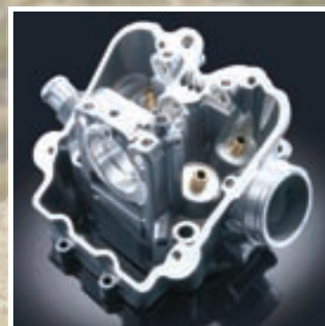
▲ U kompaktnoj glavi cilindra smještena je jedna bregasta osovina i 4 ventila. Usisni ventili su maksimalno olakšani jer imaju šuplje stablo, dok poklopac glave izveden pod nagibom olakšava njihovo podešavanje
