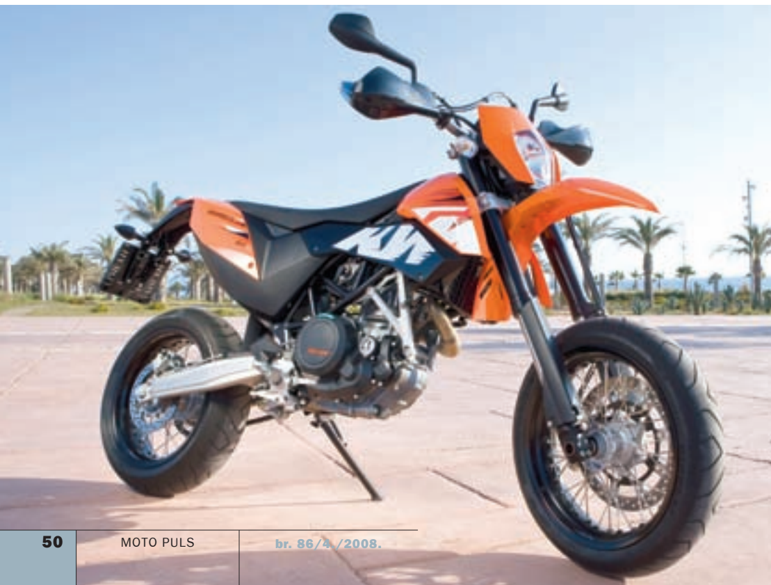
Agresivna prednja kočnica s Brembovim radijalnim klijestima i velikim diskom trenutno zaustavlja motocikl, ali i uzrokuje putovanje vozača po klizavom sjedalu
