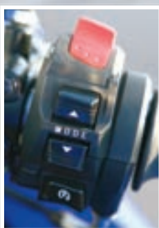
▲ Tri ponudena moda SDMS sustava biraju se putem prekidača smještenog na desnoj ručici upravljača
