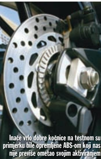
Inače vrlo dobre kočnice na testnom su primjerku bile opremljene ABS-om koji nas nije previše ometao svojim aktiviranjem
