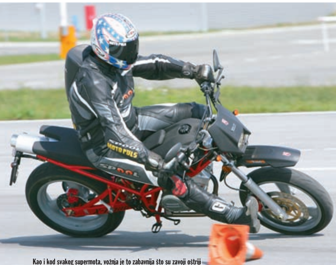
Vrlo snažan prednji kočioni sustav s diskom promjera 320 mm i njemu pripadajućim kočionim klijestima sa 4 klijesta
