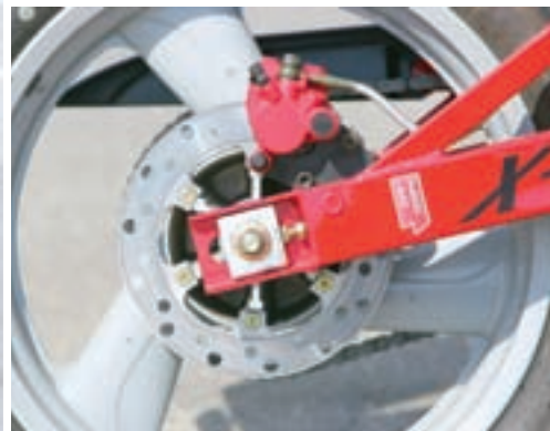
Vrlo snažan prednji kočioni sustav s diskom promjera 320 mm i njemu pripadajućim kočionim klijestima sa 4 klijesta
