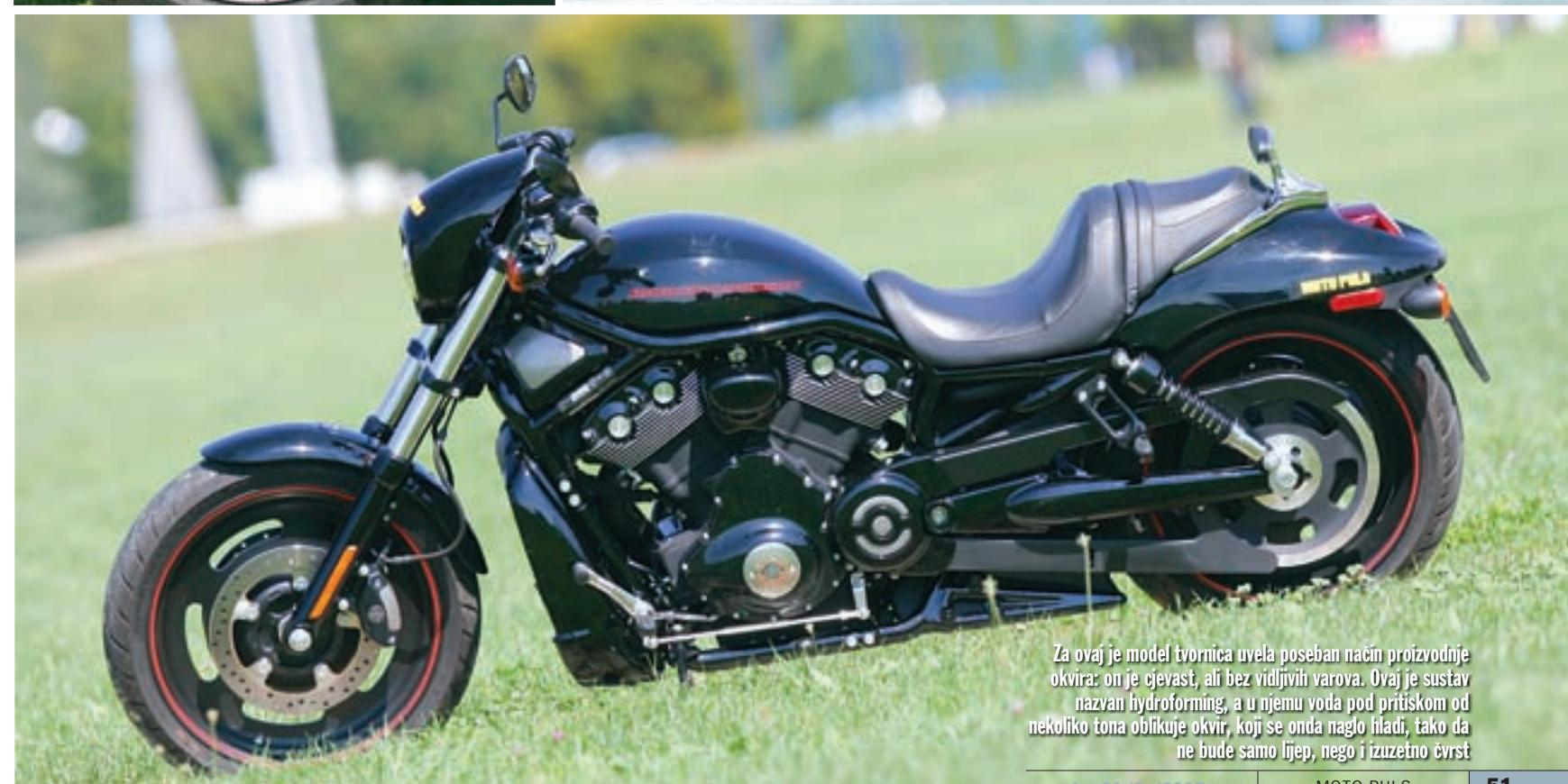
Za ovaj je model tvornica uvela poseban način proizvodnje okvira: on je cjevast, ali bez vidljivih varova. Ovaj je sustav nazvan hydroforming, a u njemu voda pod pritiskom od nekoliko tona oblikuje okvir, koji se onda naglo hlađi, tako da ne bude samo lijep, nego i izuzetno čvrst
