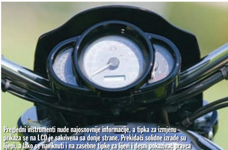
Pregledni instrumenti nude najosnovnije informacije, a tipka za izmjenu prikaza se na LCD je sakrivena sa donje strane. Prekidači solidne izrade su lijepi, a lako se naviknuti i na zasebne tipke za lijevi i desni pokazivač pravca
