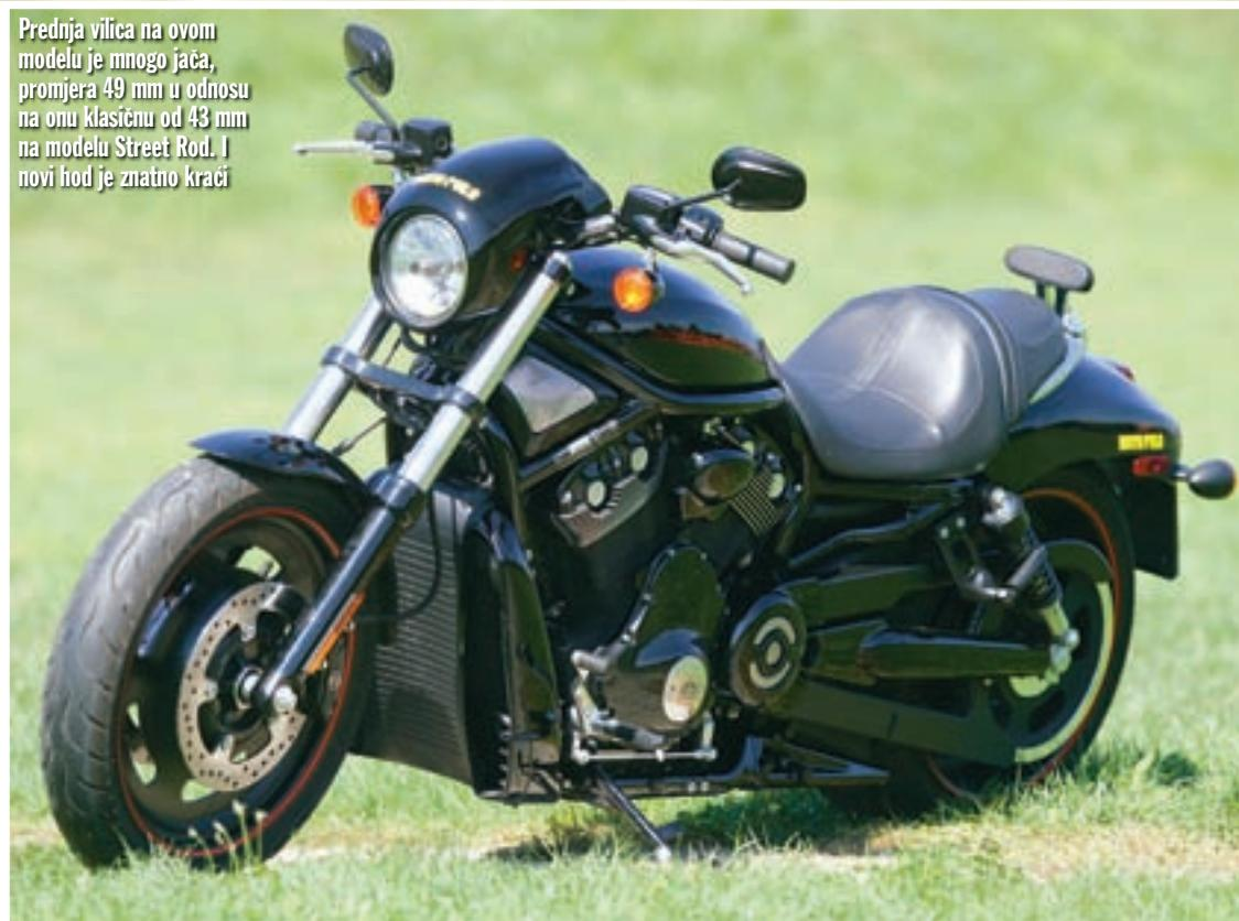
Kut prednje vilice je povećan sa 32 stupnja na 36, a to je dobiveno povećanjem kutem upravljača u mostovima vilice. To povećanje mu otežava manevriranje u mjestu, ali daje stabilnost na pravcu
