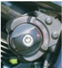
Night Rod Special posjeduje novu "keyless" tehnologiju, što bi značilo da vam ključ, koji je spremljen negdje u džepu ili najdalje na nekih 80 cm od motora, uopće ne treba, a motor pokrećete bez ključa
