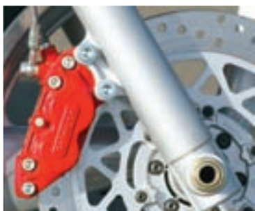
Veliki prednji disk promjera 316 mm dobro se dozira i kvalitetno obavlja svoju dužnost
