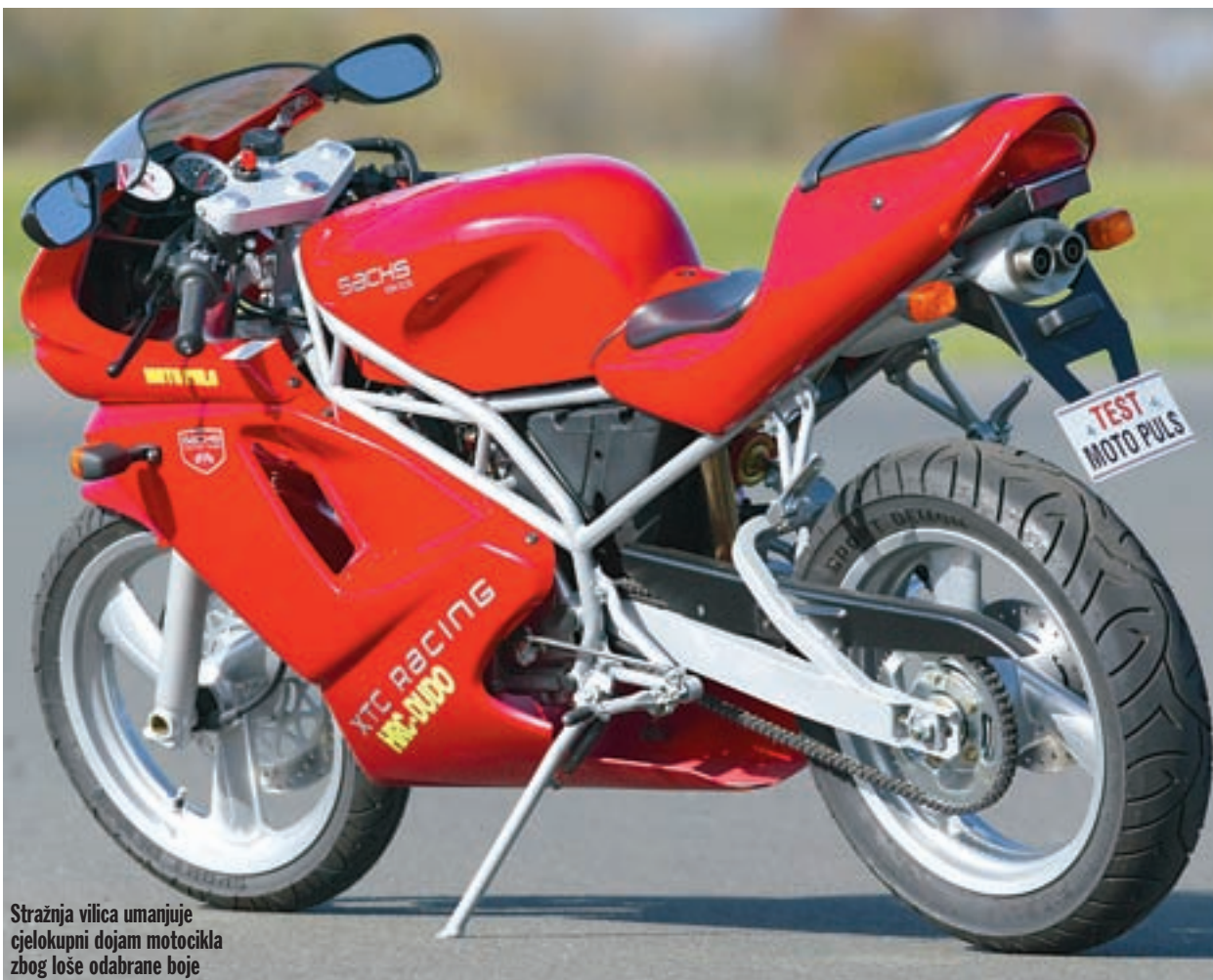
Veliki prednji disk promjera 316 mm dobro se dozira i kvalitetno obavlja svoju dužnost
