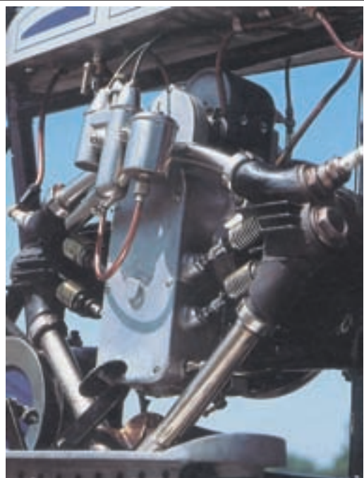
▲ Četverocilindrični 4-T bokser motor Zundapp s dvije radilice i kontra postavjenim cilindrima, dok je drugi par cilindara iznad prvog para. Vrlo interesantan projekt. Na desnoj slici vidimo presjek Zundappovog dvocilindričnog motora KS, koji je vrlo sliča BMW-ovoj konstrukciji. Ovaj motor ugrađivan je u vojne motocikle s prikolicom
