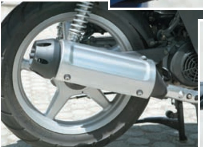
Iako se na oplatama ističe oznaka 200, ispod oplata se nalazi zračno hlađeni jednocilindraš zapremine 163 ccm
