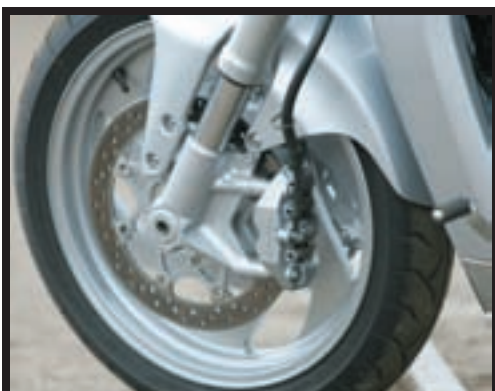
Radijalne kočnice preuzete s modela GSX-R 1000. Veliki agregat iznenađuje spremnošću na vragolije.
