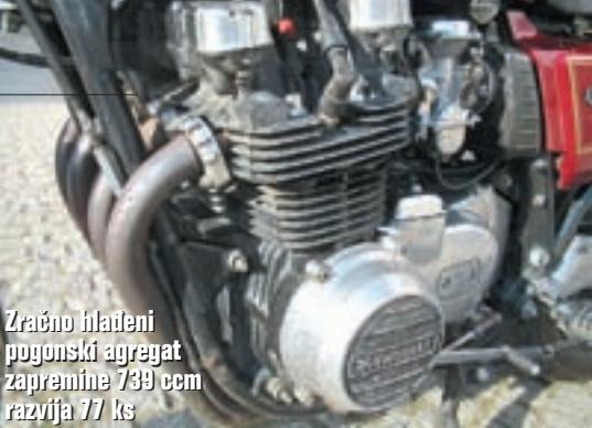
Zračno hlađeni pogonski agregat zapremine 739 ccm razvija 77 ks
