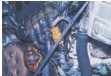
Takmičarska Honda NSR 500 s direktnim ubrizgavanjem, gdje elektromagnetske brizgaljke pod tlakom uštrcavaju gorivo u difuzor, a kontrolira ih računalo
