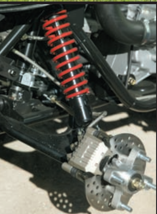
Prejednostavna konstrukcija prednjeg ovjesa je najveći nedostatak ovog četverocikla. Za razliku od prednjeg ovjesa, stražnji ovjes je riješen klasično za ovu vrstu vozila
