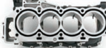
Vidimo cilindre, prostor za lanac razvoda i precizno izrađene kanale za rashladnu tekućinu
