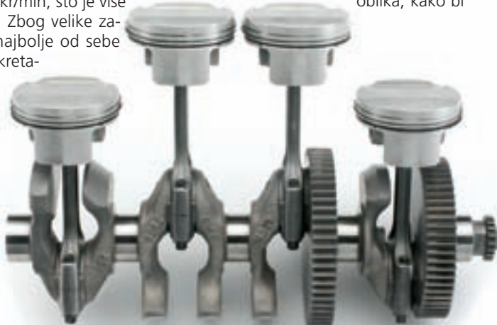
Kovana radilica s pet glavnih ležaja i dva zupčanika ravnih zuba, od kojih jedan služi za primarni prijenos, a drugi pogoni osovine za uravnotežavanje. Vidljiva su uska ramena, te utezi s provrtima za uravnotežavanje. Olakšani kovani klipovi s malim površinama za vođenje. Kao i kod drugih modernih agregata, koristi vrlo tanke prstene
