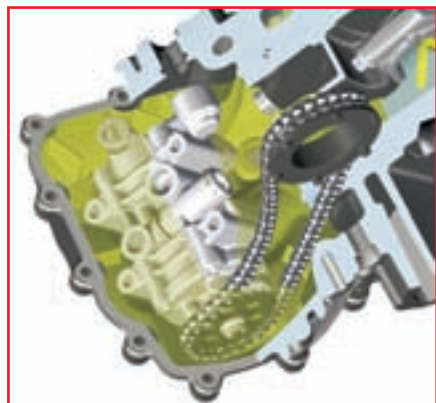
Lancem pogonjena uljna pumpa smještena je u dno kartera, pa osigurava konstantan tlak ulja i pri ekstremnim režimima motora. Zbog niskog položaja dobava je osigurana i pri nagibu od 90°, dakle pri padu
