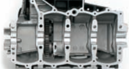
Gornja strana donjeg dijela bloka motora. Vidljivi su provrti cilindara, 5 kliznih poluležaja, te uljne brizgaljke za hlađenje klipova
