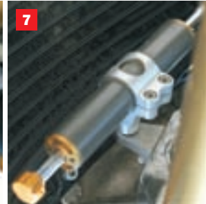
(1) Oslonci za noge djeluju vrlo efektno (2) Šiljati zubi "špice" ugrađuju se samo u izložbene svrhe (3) Osim atraktivnog izgleda cjevasti okvir CrNiMoTi 4404 odlikuju velika čvrstoća i mala težina (4) Upravljački sklop je također ručne izrade (5) Unikatni "konjići" (6) Masivni mostovi upravljača vrlo su efektni (7) Amortizer upravljača od Yamaha R1
