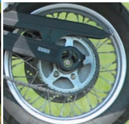
Zatezanje pogonskog lanca obavlja se uz pomoć ekscentra
