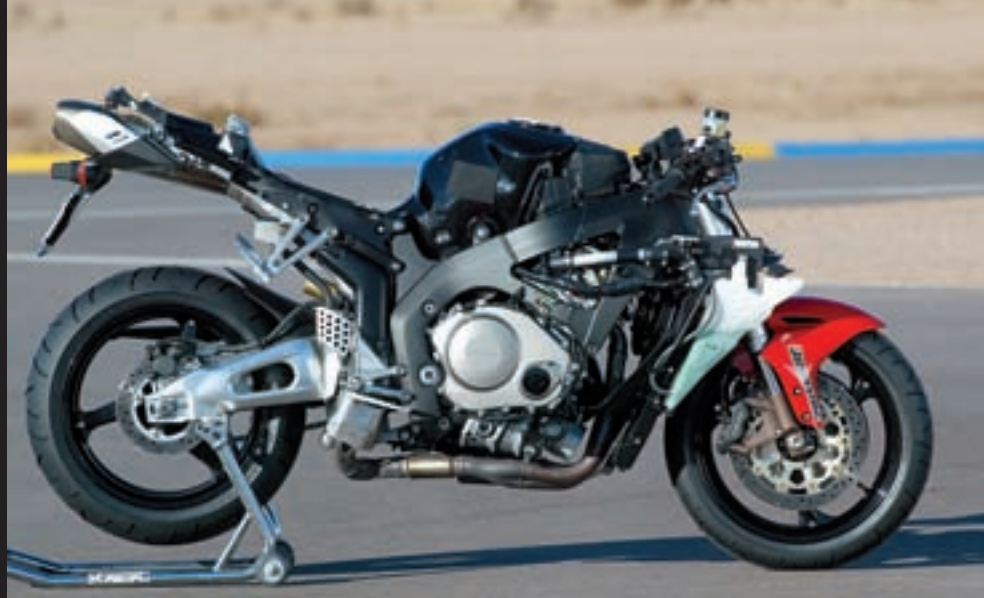
Gabariti CBR-a 1000 ne premašuju one koje smo navikli vidjeti u klasi 600. Zanimljivo je riješen smještaj spremnika goriva, kao i presjek ispuha, dolje
