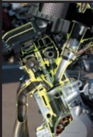
Slika pokazuje smanjeni kut među ventilima, te dva injektora na usisu po cilindru
