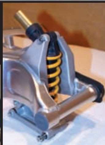
Okrenuti stražnji sustav ovjesa direktna je kopija Rossijeve RC 211V
