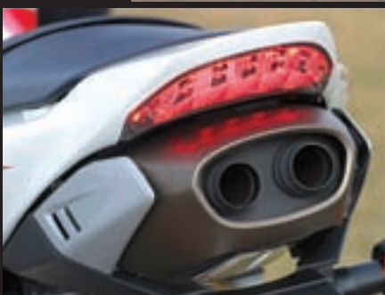
Ispušni ventil najzaslužniji je za smanjenje buke, ali pomaže i u "peglanju" krivulja snage na srednjim režimima
