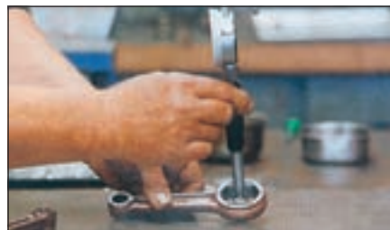
Slika osovine klipnjače. Kod 2-T motora nema kanala za podmazivanje, dok su kod 4-T motora to maleni provrti koji predstavljaju magistrale za protok uljnog tlaka. Treba biti pažljiv prilikom montaže kako bi se provrti podudarali. U protivnom će doći do destabilizacije uljnog tlaka
