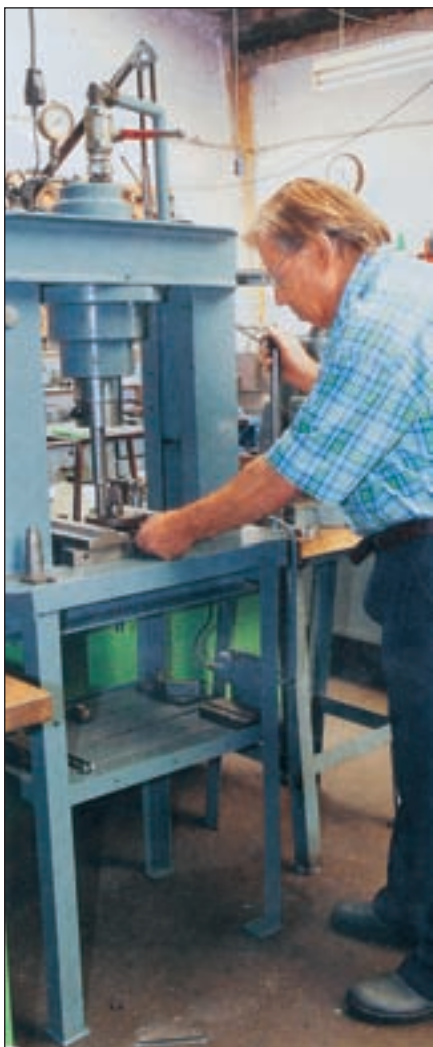
Preša od 20-ak tona biti će osnovni i nužni alat za isprešavanje i uprešavanje klipnjače u utege radilice
