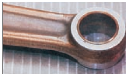
Brončana puškica u gornjem provrtu klipnjače sklona je habanju. Klipnjača se također treba podvrgnuti linearnom ispitivanju na ravnoj površini ili paralitetom provrta
