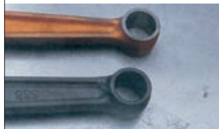
Slika osovine klipnjače. Kod 2-T motora nema kanala za podmazivanje, dok su kod 4-T motora to maleni provrti koji predstavljaju magistrale za protok uljnog tlaka. Treba biti pažljiv prilikom montaže kako bi se provrti podudarali. U protivnom će doći do destabilizacije uljnog tlaka
