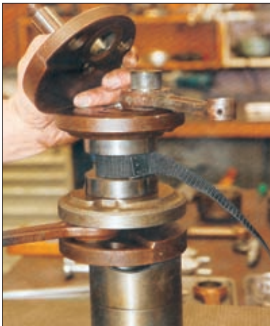
Nakon isprešavanja gornje polutke radilice moguće je izvoditi klipnjaču koja na ovoj slici ima karakterističan kvar
