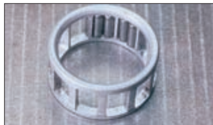
Zbog visoke temperature igličasti ili valjkasti ležaj mora biti u aluminijskom ili posebnom metalnom kavezu
