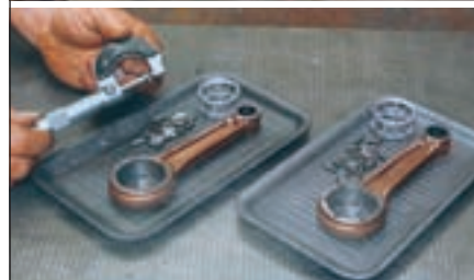
Mjerenje je sljedeća faza operacije. Moramo imati mikrometar za kontrolu rolica i osovinu klipnjače, te komparator sa subitorima za mjerenje unutarnjeg provrta klipnjače
