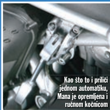
Mehanizam ručne kočnice djeluje na stražnji disk motocikla
